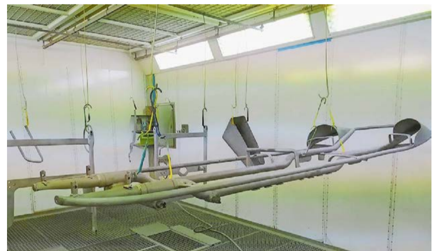
Links oben: Da der Bob an verschiedenen Stellen deformiert war, musste er zunächst gerade gebogen werden. Links unten: Im Anschluss wurde er in Einzelteile zerlegt und sandgestrahlt. Rechts unten: Nach dem Sandstrahlen folgte die Grundierung. Rechts oben: So sieht der Bob aktuell aus. Der nächste Schritt ist das Lackieren. Die Fussstützen (silbergraue Bleche) mussten die Lernenden neu anfertigen, da die alten durchgerostet und nicht mehr brauchbar waren. Bilder: zvg
